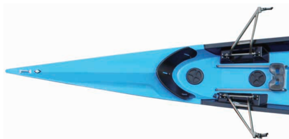
CO4x+ スライディングタイプのウェーブブレイクと2種類のハッチ
