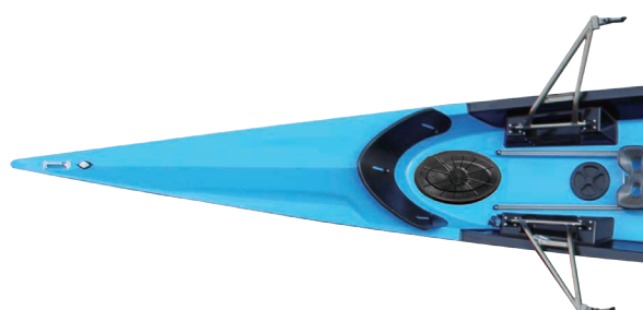
CO4x+ スライディングタイプのウェーブブレイクと2種類のハッチ
